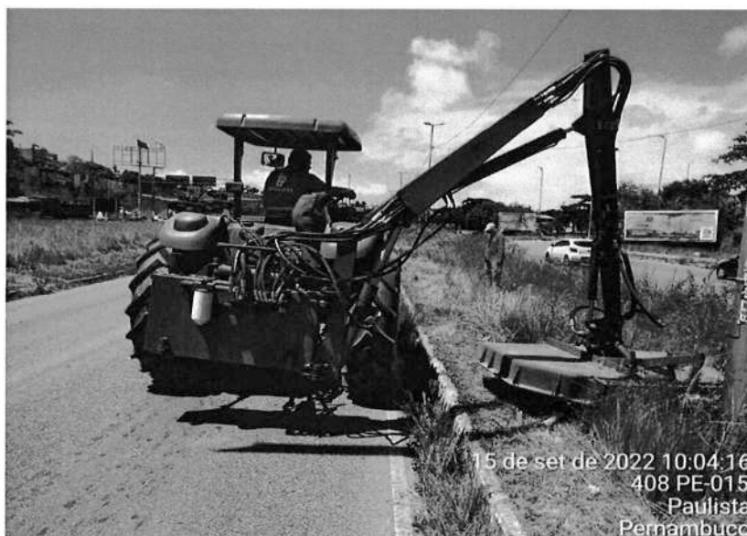
Figura 11 – Roçadeira acoplada em Trator Agrícola
